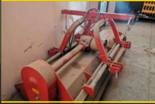
Débroussailleuse à marteau
