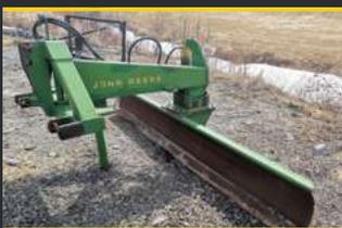
Lame niveleuse John Deere 10 pi avec angle verticale et horizontale - Stock # 2108g
