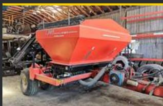
Épandeur d'engrais à rampe 40 pi au 30 po ADLS
