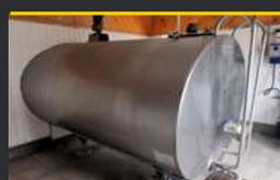
Réservoir Delaval 2000 gallons avec refroidisseur
